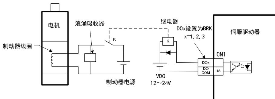
驱动器的CN1插头5脚，默认电磁制动输出。
