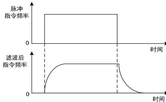
滤波器使输入的脉冲频率平滑化。此滤波器用于：上位控制器无加减速功能、电子齿轮比较大、指令频率较低等场合。
