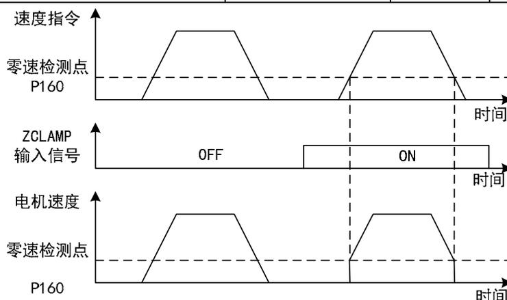
速度控制时，即使电机是零速，也可能会外力发生旋转导致位置变动。如果是模拟量速度指令输入，绝对零速指令也是不容易实现的，为了解决这两个问题，可以考虑使用零速箝位功能。当下列条件满足时，零速箝位功能开启：
